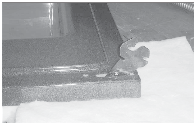
Photo B. Insérez le crochet charnière de la porte dans le passage de charnière du cadre frontal.
